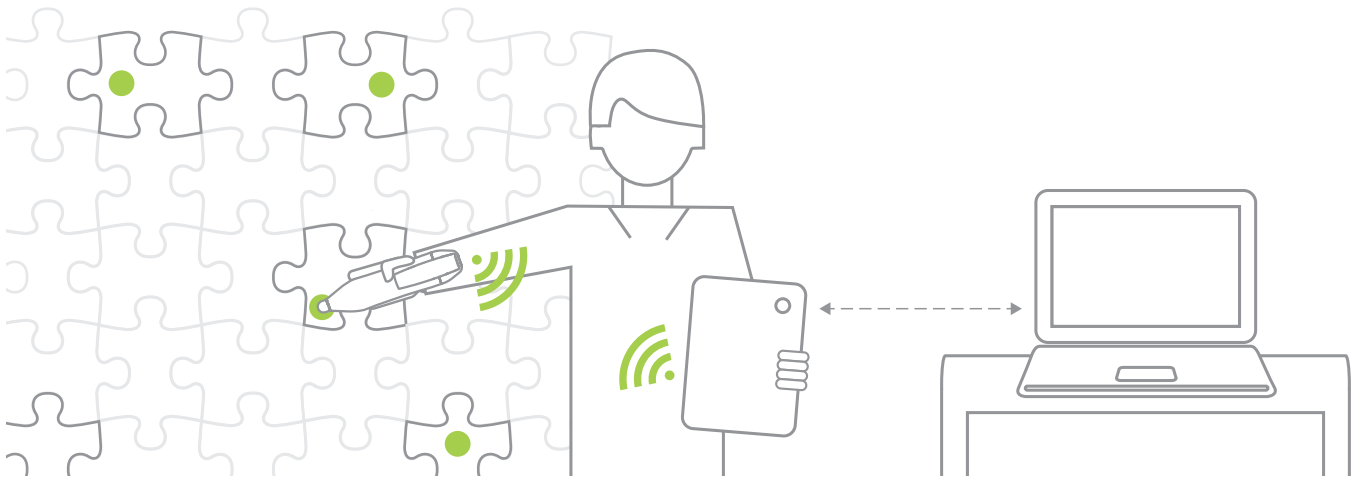
schematische Darstellung des CONEXO Systems im Zusammenspiel von RFID-Tag, Pen, App und Portal
